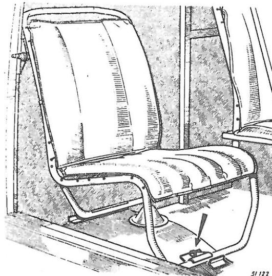
Sièges conducteur et passager se composent d'un coussin et d'un dossier à éléments élastiques matelassés et garnis de simili-cuir, qui sont fixés sur l'armature par des crochets de tension, pattes de rappel et agrafes "Raymond".
